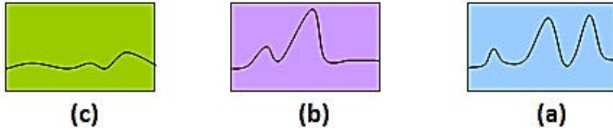
الشكل (6-2): حيود الأشعة السينية (XRD) للأغشية رقيقة [78]: a. متعددة التبلور b. أحادية التبلور c. غير بلورية.
